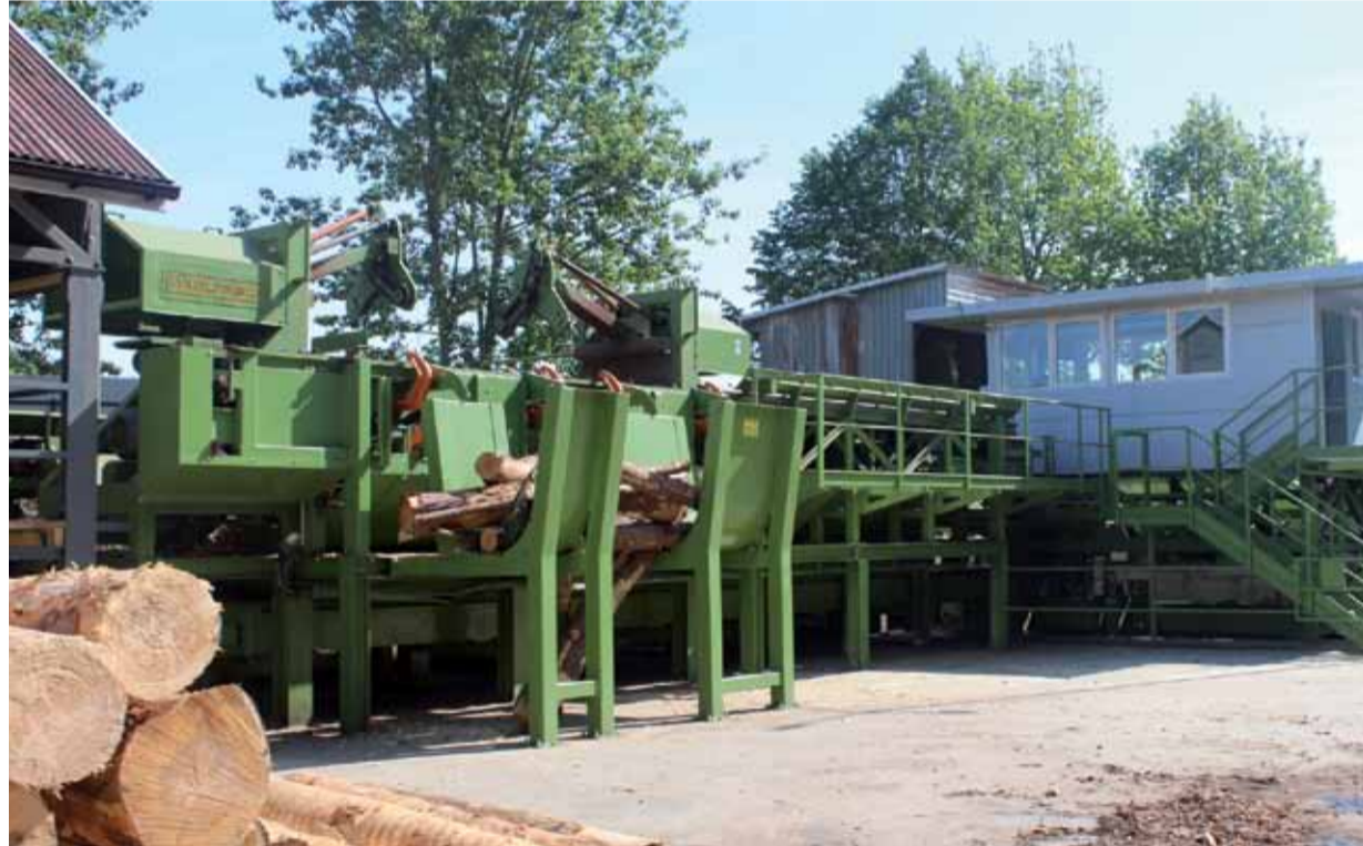
Ciąg technologiczny umożliwiający sortowanie, formatowanie oraz korowanie kłód – wraz z redukcją napływów korzeniowych – działający już w Jordanowie.
