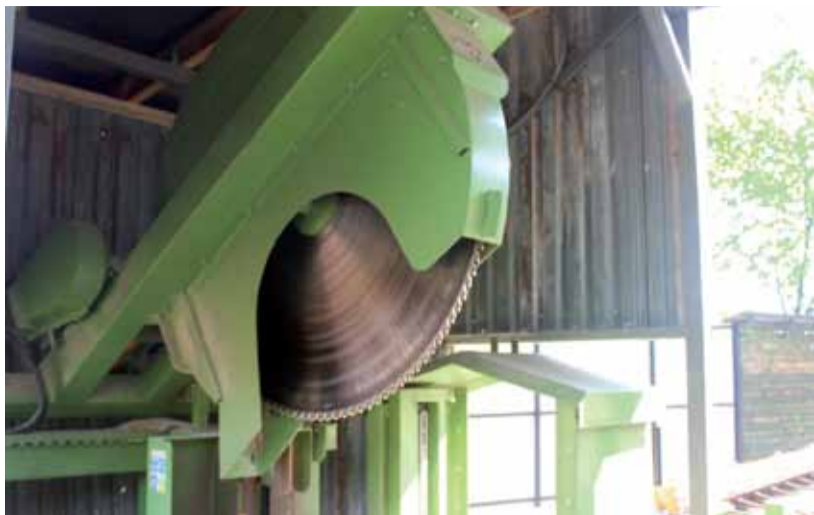
W ciągu pracuje piła o średnicy zależnej od wymaganego cięcia – od 1,25 do 1,6 metra.
