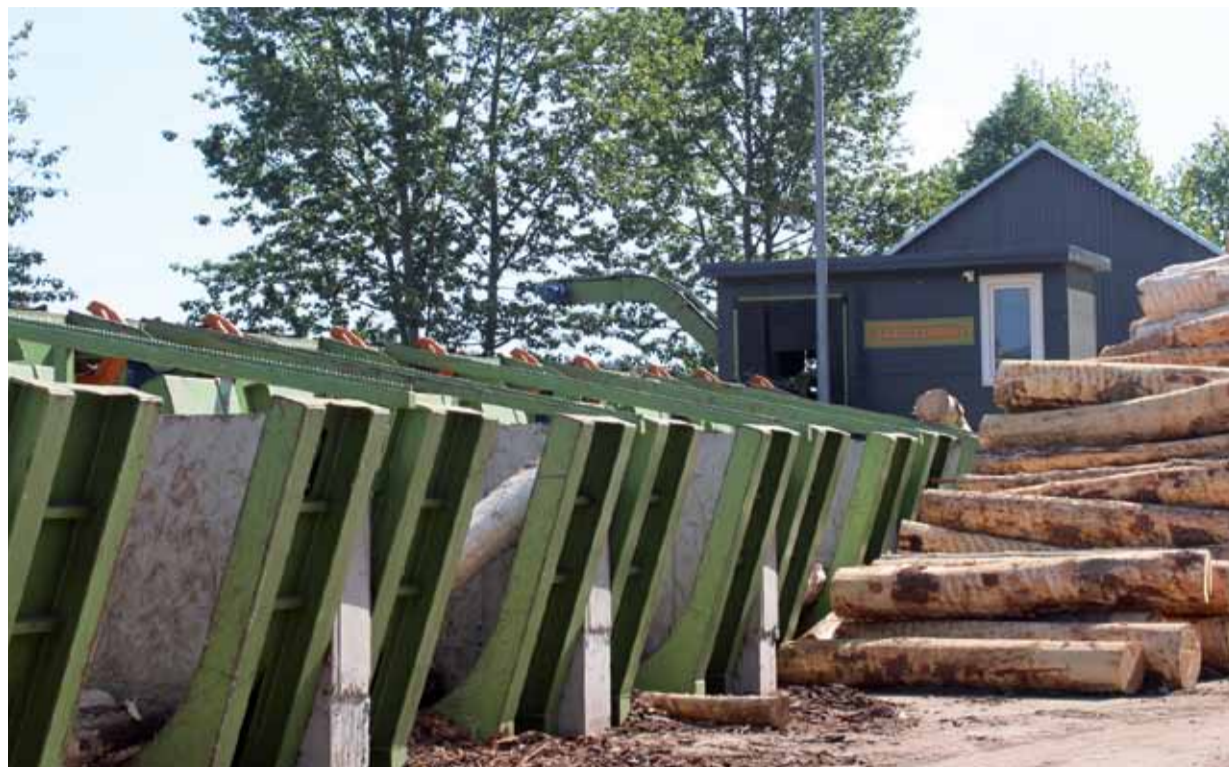
Ciąg technologiczny umożliwiający sortowanie, formatowanie oraz korowanie kłód – wraz z redukcją napływów korzeniowych – działający już w Jordanowie.
