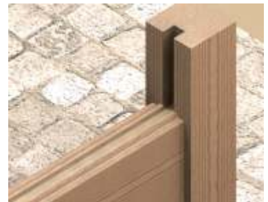
Pół czenie sumikowo-ł tkowe chroni ce drzwi i okna przed osiadaniem budynku.
