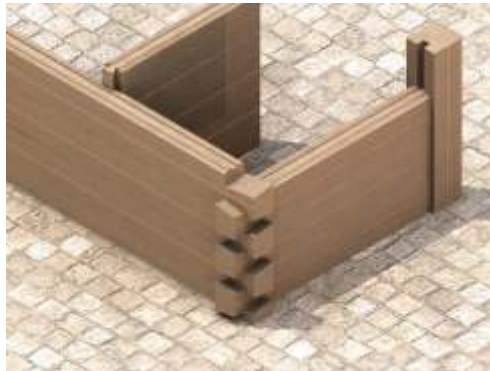
Pół czenie ciany zewn trznej ze ciany wewn trzn na półzamek teowy w jaskółczy ogon.
